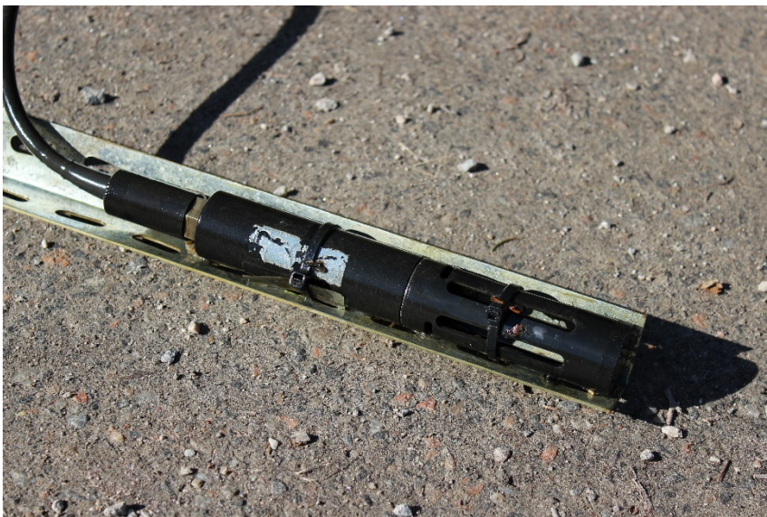
Sensorn som sänks ner i brunnen för att mäta förekomst av olja i vattnet.
